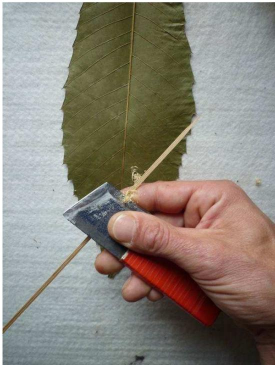
Refendre cette baguette en 2. On obtient donc 2 baguettes d'1 mm d'épaisseur et 1 ou 1,5 mm de large. La 2<sup>ème</sup> nous servira pour faire le balancier.
